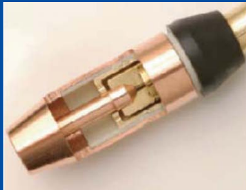
Figura 2 – Tocha com sistema único de fixação do bocal, bico e difusor do gás.
