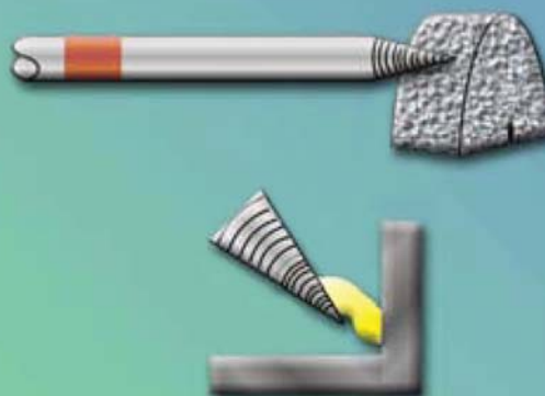
Preparação Incorreta Arco Irregular
