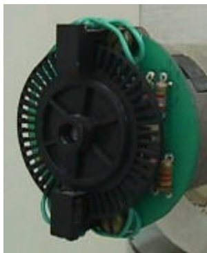
Figura 4.2 - Exemplo de encoder óptico incremental
