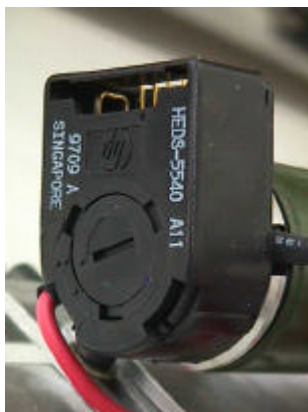
Figura 4.4 - Exemplo de encoder óptico comercial (pedir permissão para HP)
